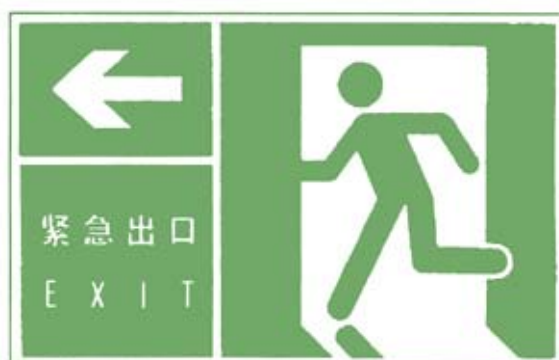
图 A2-4 图形、箭头和辅助文字组合形成的标志灯面板图示例
